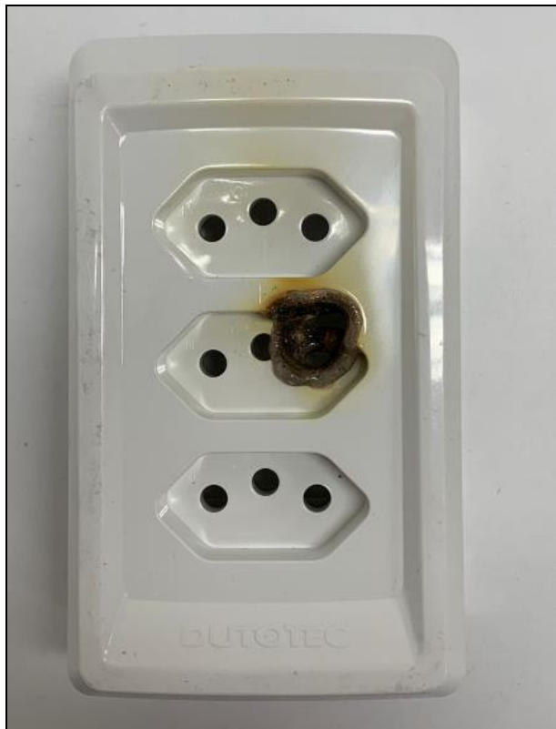
Figura 6 – Vista da amostra DT 67000.22 após o ensaio a 750°C.
