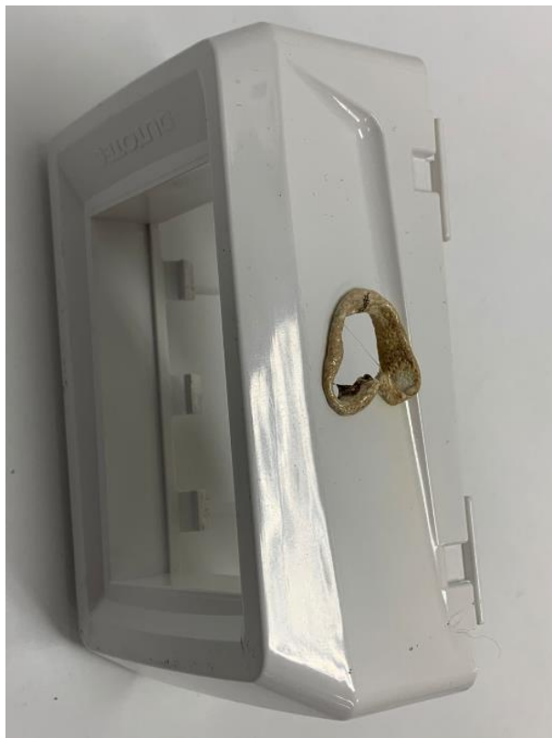
Figura 8 - Vista da amostra DT 64444.20 após o ensaio a 650°C.
