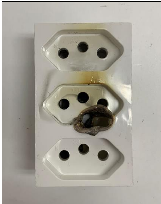
Figura 7 - Vista da amostra DX 97233 após o ensaio a 750°C.
